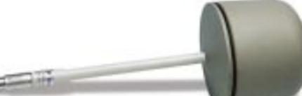
**HP-050** - Sonda isotropica per campi magnetici a frequenza industriale; da 10 Hz a 5 kHz. F.S.: 40  $\mu$ T. Sensibilità: 10 nT.
